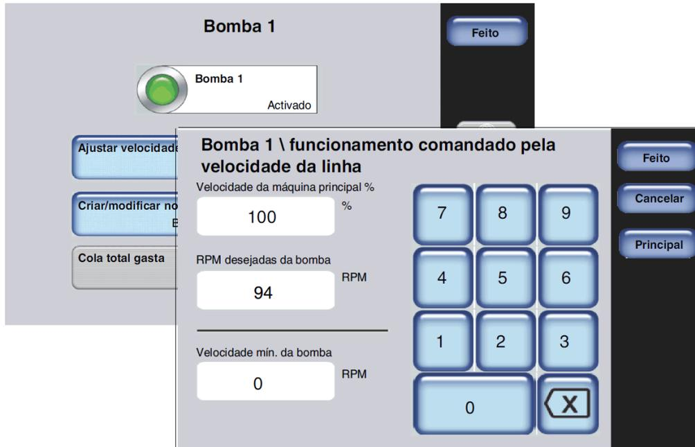
Fig. 5-6 Configuração e ajuste do modo de funcionamento comandado pela velocidade da linha
